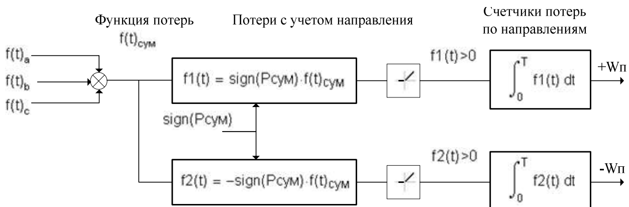
Рисунок 4 – Алгоритм суммирования и определения направления при учете потерь
